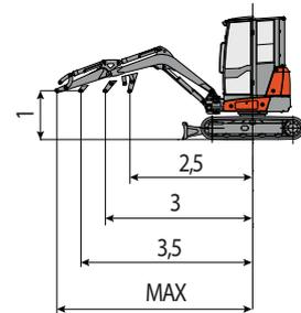
Hebekraft basierend auf ISO-Norm 10567 und überschreitet nicht mehr als 75% der Kippplast oder 87% der hydraulischen Hebe-Kapazität der Maschine.
