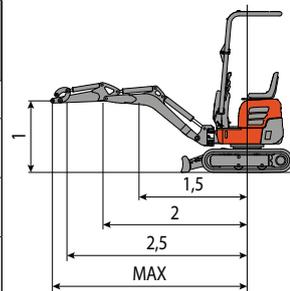
Hebekraft basierend auf ISO-Norm 10567 und überschreitet nicht mehr als 75% der Kipplast oder 87% der hydraulischen Hebe-Kapazität der Maschine.
