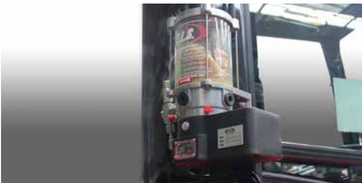
Automatische Fett - Zentralschmierung
