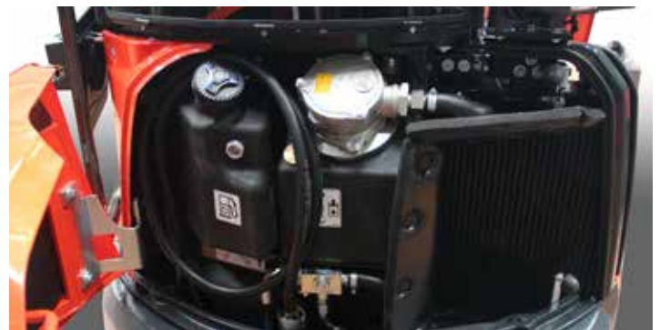
Elektropumpe Einfüllung Dieselkraftstoff
