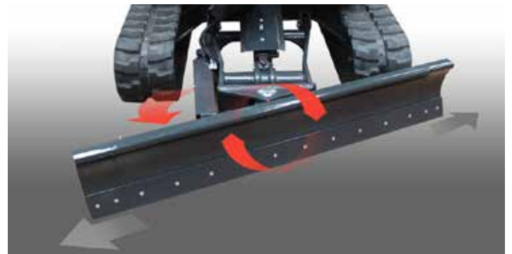
Hydraulisches Frontschild Angle Tilt Dozer mit Verlängerung und zusätzlicher Kantenschoner
