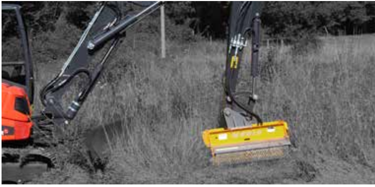
Hydraulikanlage, einfach/doppelwirkend mit elektrischen vorgesteuertem Nachlass (70 l/Min.)
