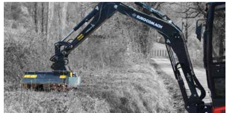
Hydraulikanlage, einfach/doppelwirkend mit elektrischen vorgesteuertem Nachlass (50 l/Min.)
