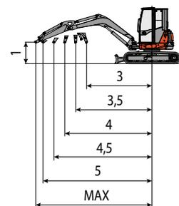
Hebekraft basierend auf ISO-Norm 10567 und überschreitet nicht mehr als 75% der Kippplast oder 87% der hydraulischen Hebe-Kapazität der Maschine.
