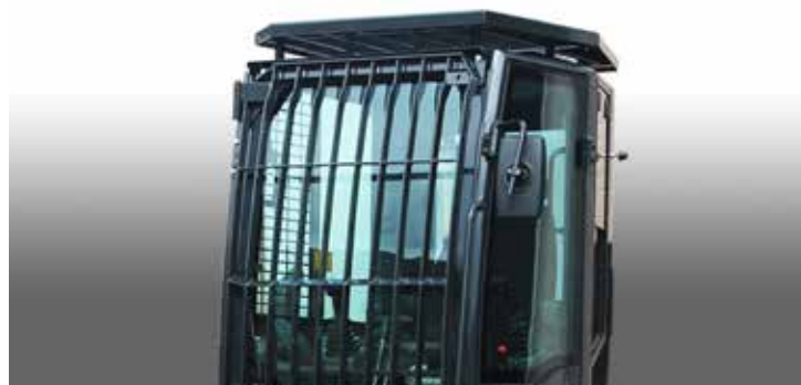
Zusätzliche vordere und obere Schutzgitter, FOPS Stufe 2 zertifiziert
