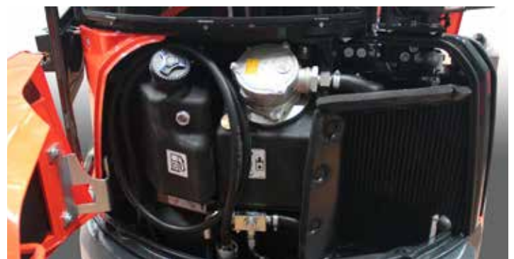
Elektropumpe Einfüllung Dieselkraftstoff
