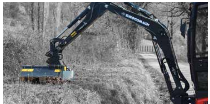
Hydraulikanlage, einfach/doppelwirkend mit elektrischen vorgesteuertem Nachlass (50 l/Min.)
